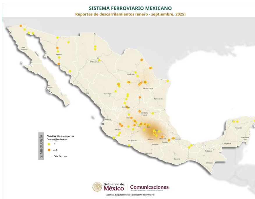
Figura 6. Localización de reportes de descarrilamiento.
